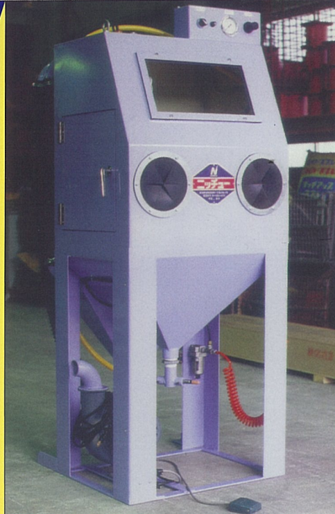
サイドドア（両面）各タテ410mm ヨコ360mm
